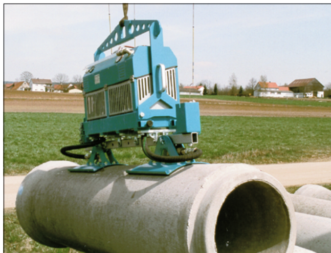
Kappa-Levator mit Verbrennungsmotor, Trägersystem mit 2 Sonder-Saugplatten für Rohre DN 500, Tragfähigkeit 1.000 kg.
