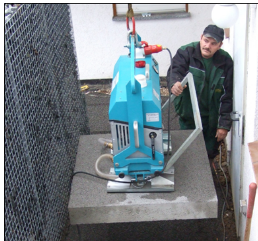
Kappa-Levator mit Elektromotor, Tragfähigkeit 800 kg.
