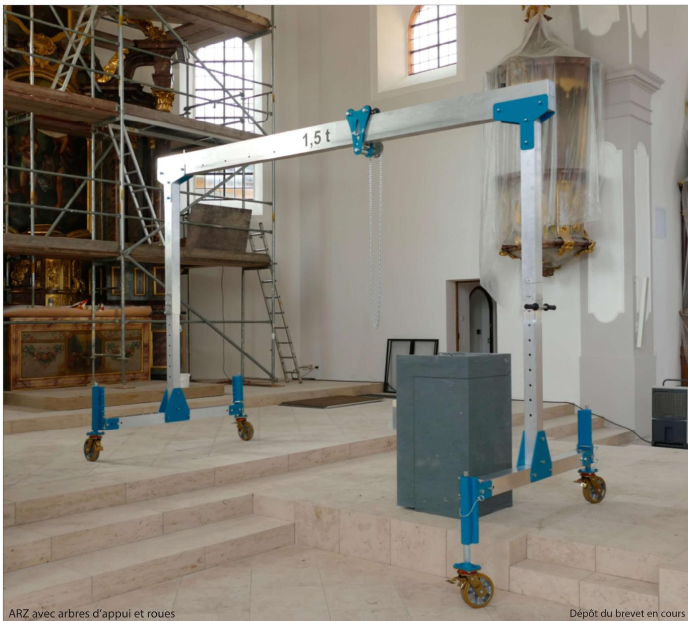
ARZ avec arbres d'appui et roues
