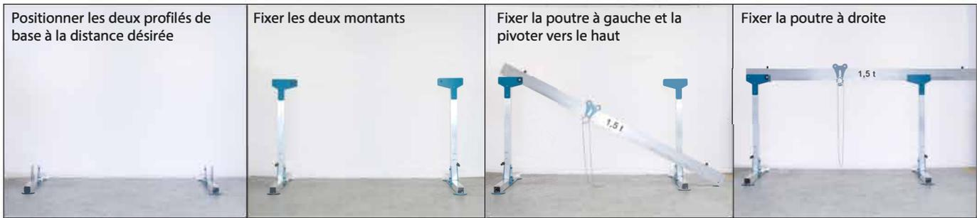
Poutre et montants sont fabriqués en profilés en aluminium léger. Ainsi l'assemblage peut être vite réalisé par une personne. La portée est réglable d'un côté par tranches de 300 mm. La hauteur peut être réglée à l'aide des axes de chaque côté par intervalles de 100 mm. Un chariot sur roulement à billes avec dispositif de blocage est inclus dans la livraison. Celui-ci peut être facilement déplacé sur la poutre en poussant la charge.
