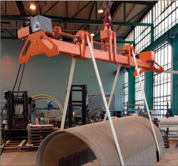
422 620 WTVE 2/2: Capacité de charge 2 t, largeur de travail min./max. 500/2,000 mm, réglable avec de axes, avec contre-poids
